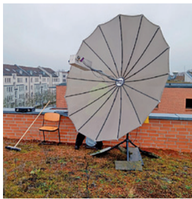
Mobile Sendestation für Erde-Mond-Erde-Funkverbindungen in Schulen. Bildquelle: Privat
